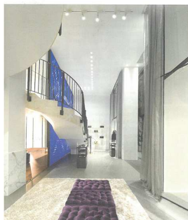
L'area di vendita dell'ingresso è caratterizzata da un volume a doppia altezza dove sono inseriti incassati a soffitto e proiettori su binario per lasciare a soffitto più neutro possibile e garantire livelli necessari The entrance area is marked by a double height volume where recessed lights and track spotlights were chosen in order to leave the ceiling as neutral as possible and ensure the required levels of lighting
